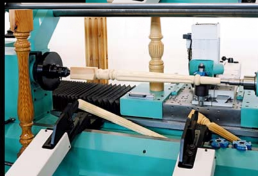
OPTIONAL: Unit group for twisting and/or grooving OPCIONAL: Grupo cabezal porta-fresas para rallar y/o hacer salomónico
